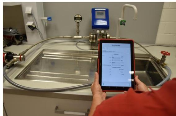
Jede der etwa 3.000 Pumpen, die jährlich das GATHER-Werk verlässt, wird vor der Auslieferung im Rahmen der Qualitätssicherung unter anderem bezüglich der Leistungsmerkmale explizit geprüft. Zu diesem Zweck stehen Prüfstationen zur Verfügung, an denen die Mitarbeiter unterschiedliche und auch kundenindividuelle Anforderungen simulieren und so die Leistungsfähig-
